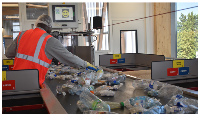
Les agents valorisateurs contrôlent la qualité du tri effectué par les machines.
